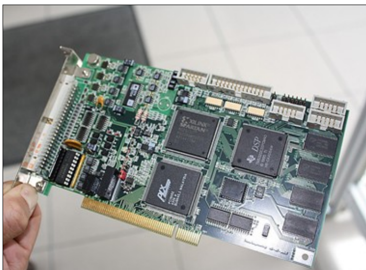
Voor het aansturen van de bedradingsrobot gebruikt ontwikkelaar Atos Engineering zelf ontwikkelde stuurkaarten
