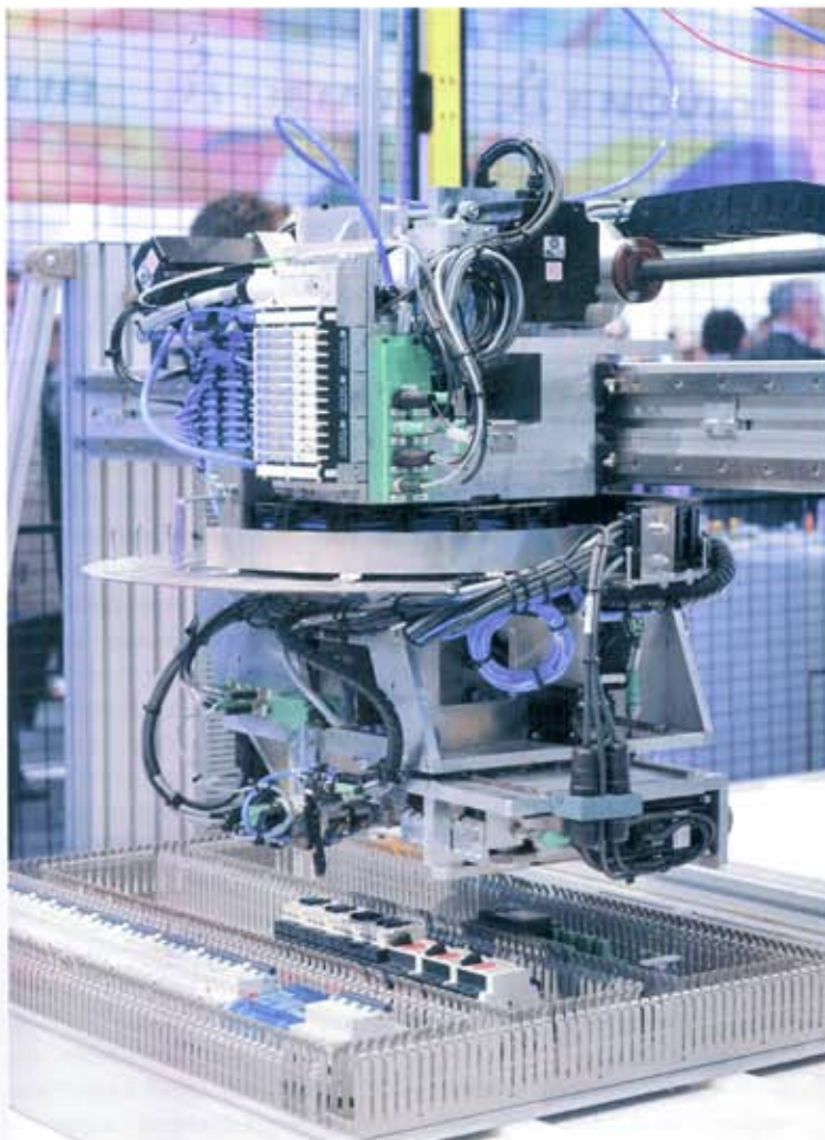
Der neu entwickelte Verdrahtungsroboter übernimmt vollautomatisch alle fertigungsrelevanten Schritte der Verdrahtung.
